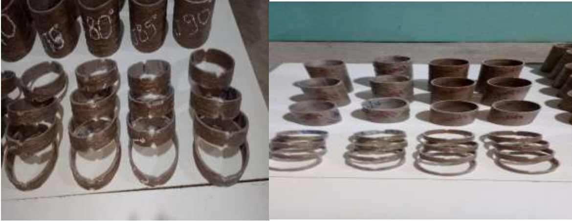
Figure III 24 Découpage des éprouvettes de tubes composite fabriquer par la machine d'enroulement filamentaire
