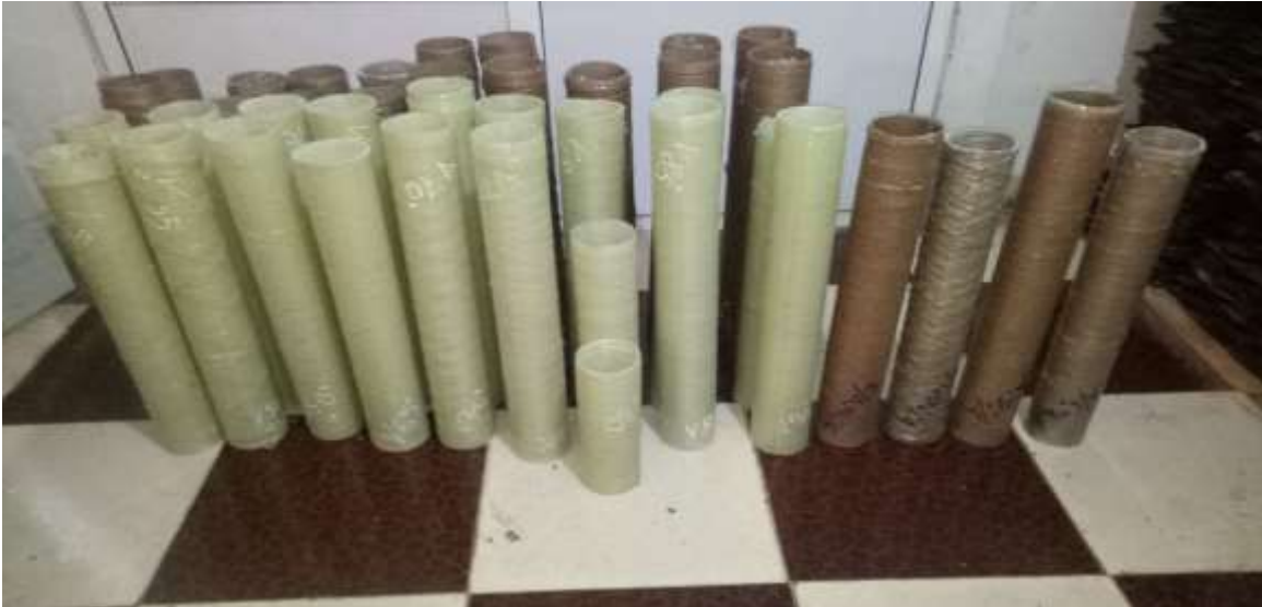
Figure III 22 Photo des tubes composite fabriquer par la machine d'enroulement filamentaire
