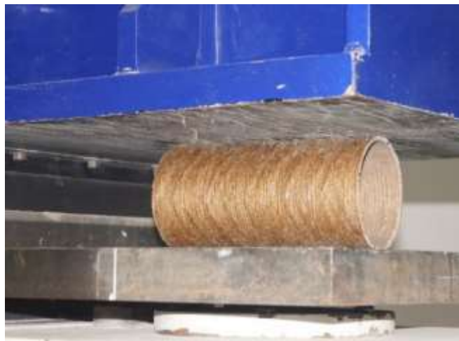
Figure IV 1..Machine et dispositif de test de compression (rigidité
