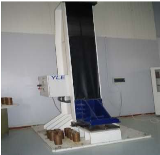
Figure IV 1..Machine et dispositif de test de compression (rigidité
