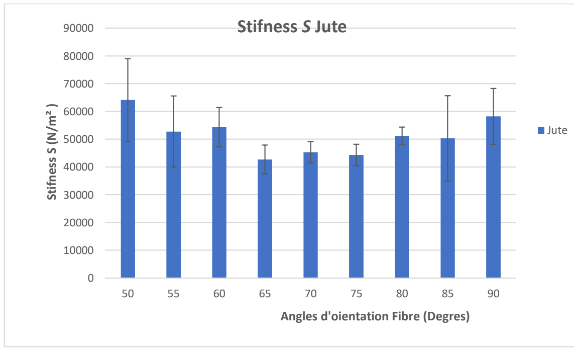
Figure IV 7. Evolution de La Rigidité spécifique en fonction d'angle d'orientation des fibre \alpha pour Jute /Epoxy
