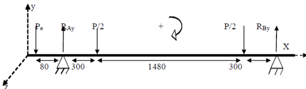
Figure II 4 Schéma illustre les efforts sur la barre dans le plan (xoy).
