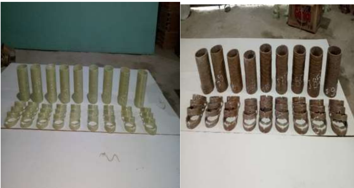
Figure III 22 Photo des tubes composite fabriquer par la machine d'enroulement filamentaire
