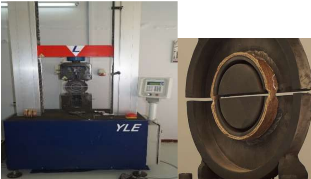
Figure IV 3. Dispositif de test "Split disk" et éprouvette
