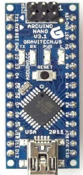
Fig II.5 : Figure réelle de l'Arduino NANO
