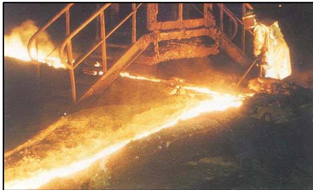
Figure II.1: Coulée de Laitier à la sortie du Haut Fourneau
