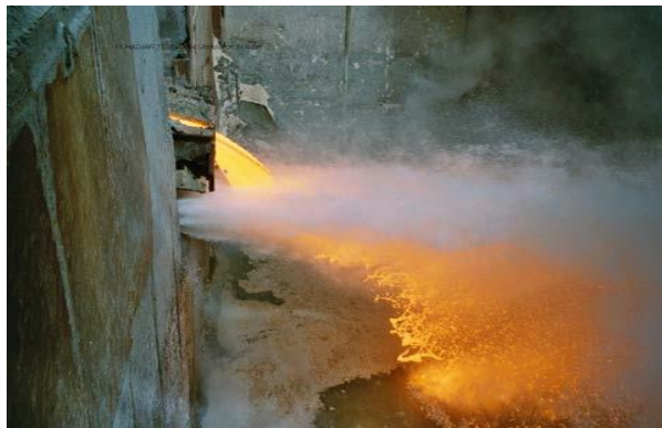
Figure II.4: Granulation et trempe du Laitier à sa sortie du Haut Fourneau d'El-Hadjar
