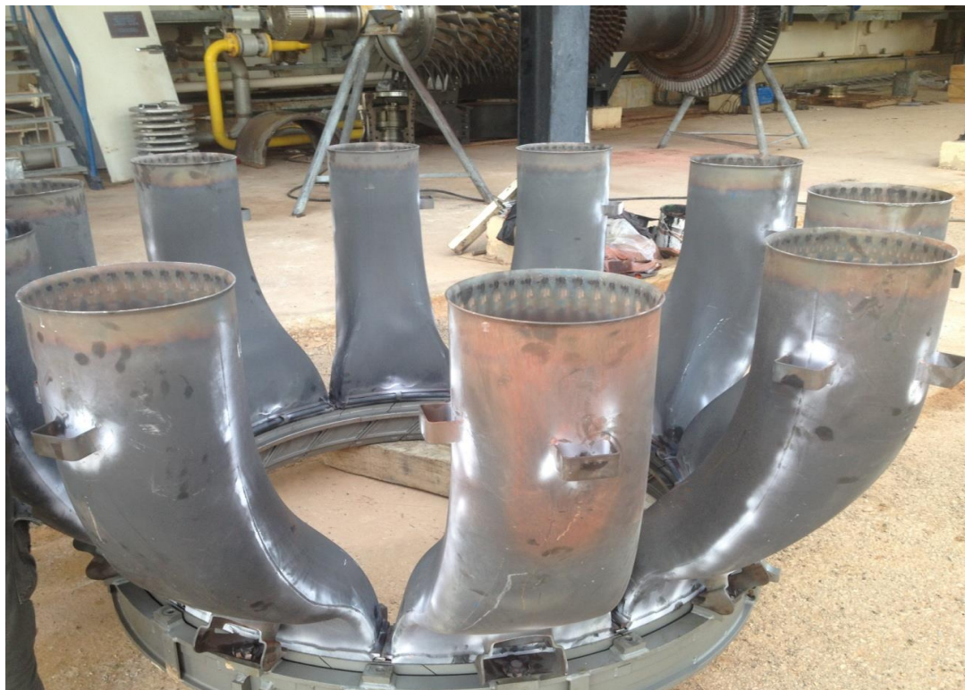
Figure III-8 : pièce de transition
