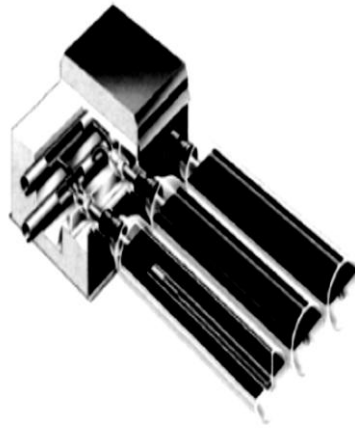
Figure 6 : Raccordement hydraulique de capteurs sous vide (Desmons, 2009)
