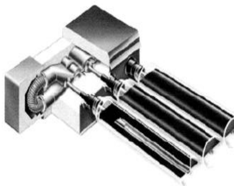
Figure 7 : Vue de capteurs à tube sous vide à caloduc (Desmons, 2009)
