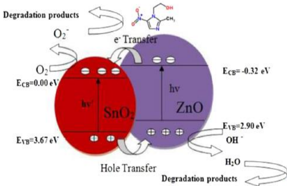
Figure I-14 : Mécanisme de dégradation semi-conducteur, semi-conducteur[20]
