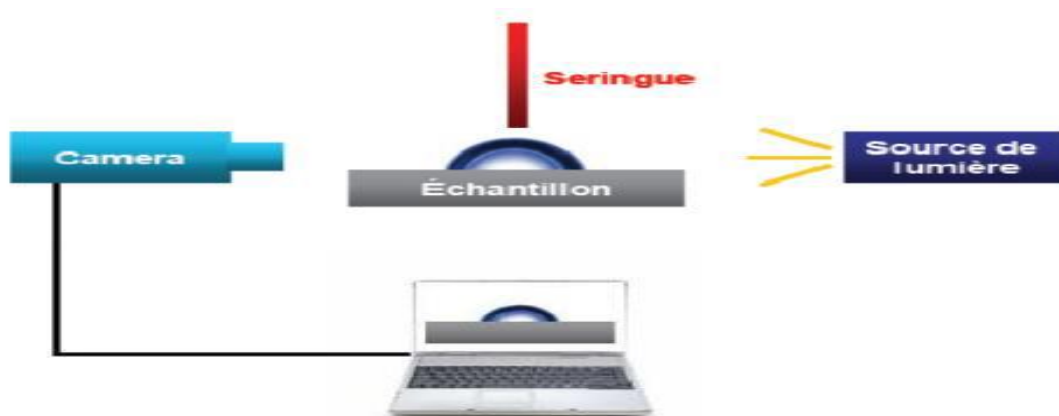
Figure II-17 : L'appareil utilisé pour mesurer l'angle de contact.
