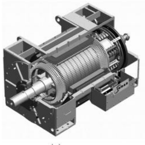
Figure 16. Représentation CAD de la MADA[19]
