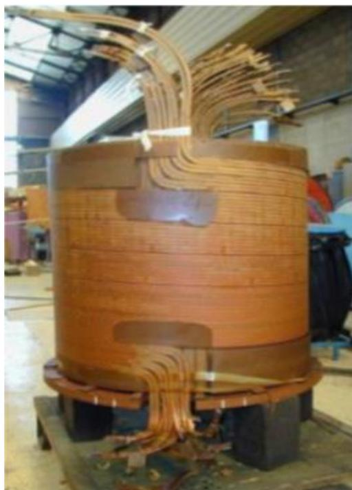
**Figure II-5:** enroulement d'un transformateur
