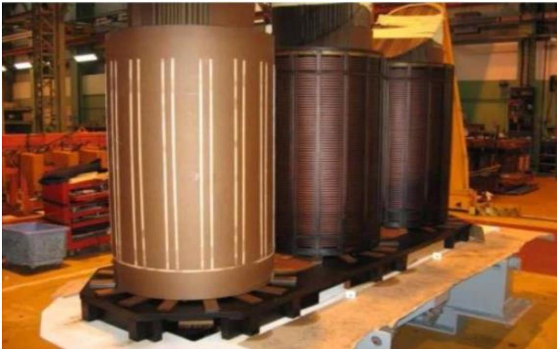
**Figure II-4:** Circuit magnétique type a colonne
