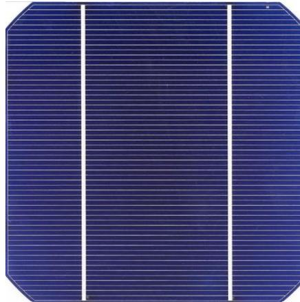
**Figure II.4** : Cellule silicium monocristallin
