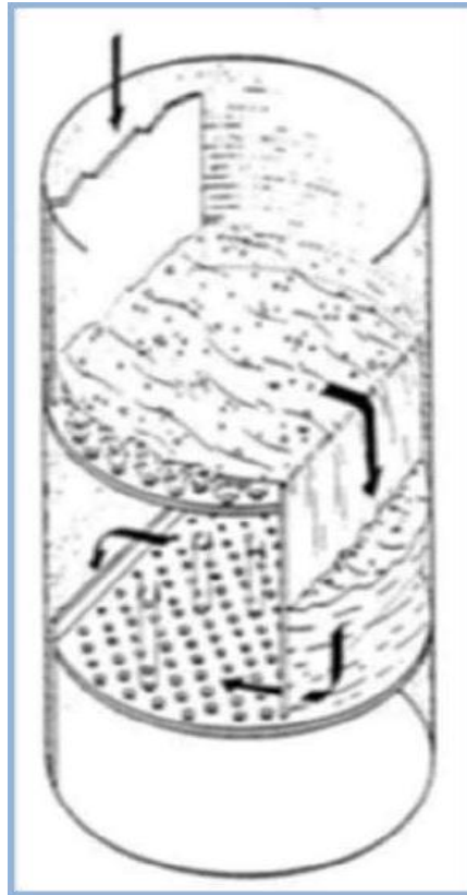
Figure V.4 L'écoulement dans une colonne à plateaux
