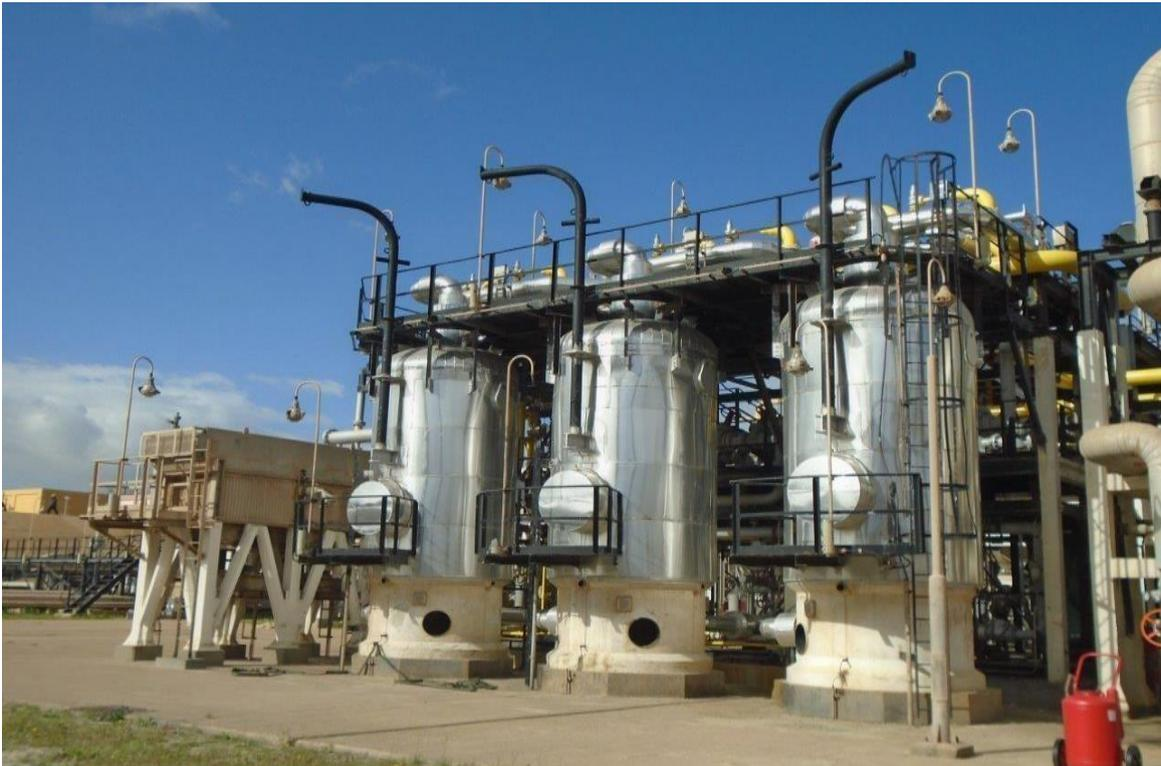
**Figure I.5 :** Colonnes d'adsorption à tamis moléculaires.
