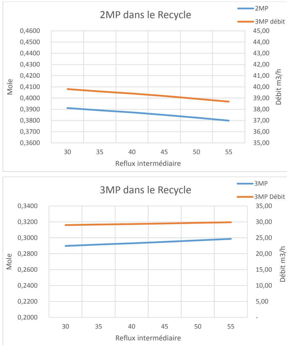
**Figure VI.10 :** Evolution de la teneur des 2MP et les 3MP dans le recycle en fonction du débit de reflux intermédiaire.
