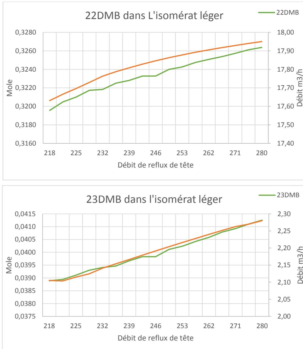
**Figure VI.7 :** Evolution de la teneur des 22DMB et les 23DMB et leur quantité dans l'isomérat léger en fonction du débit de reflux de tête.
