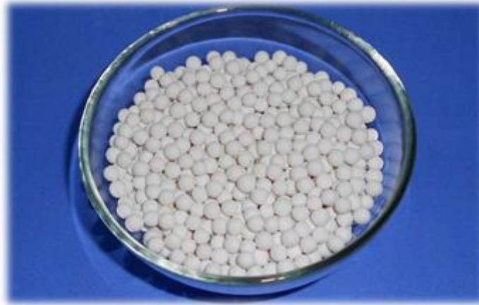
Figure II.6 : Illustration du catalyseur CR401.
