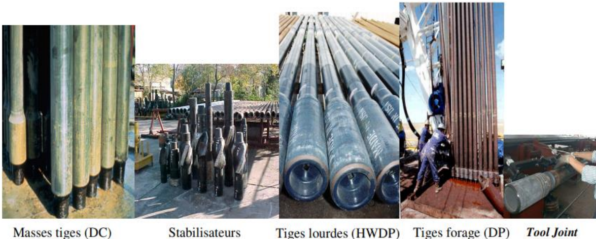
Figure I-2: Quelques éléments de la garniture de forage
