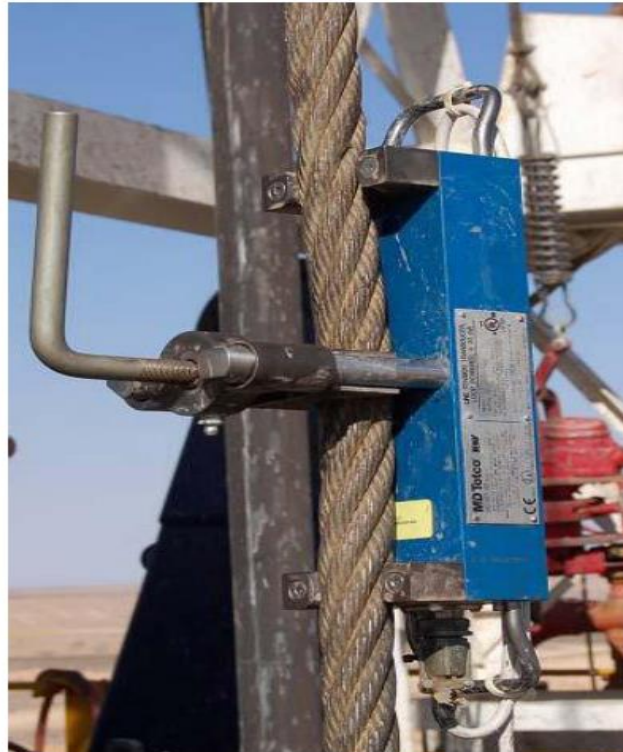
Figure II-7: Capteur du poids (Hookload sensor).
