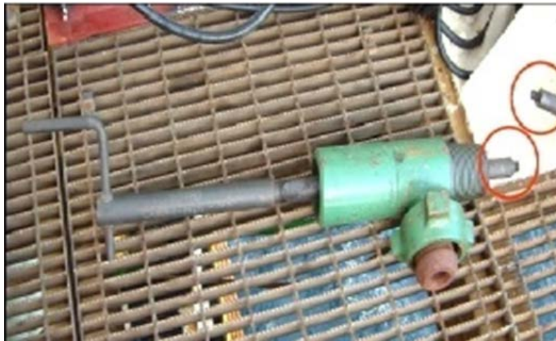
Figure II-34 - L'outil de purge des NRV
