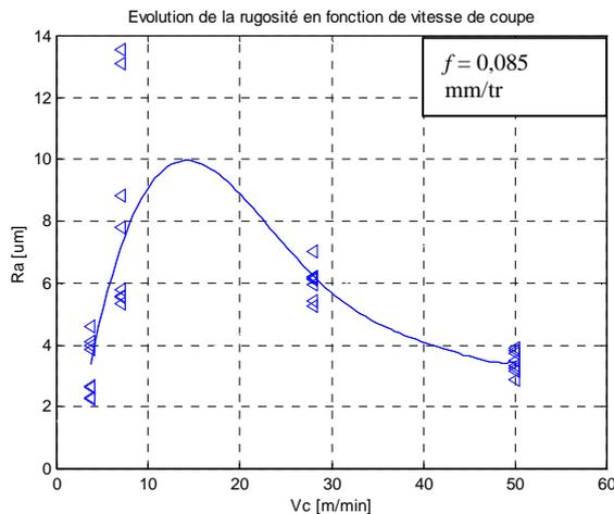
FIG. 3 - Variation de la rugosité avec la vitesse coupe.
