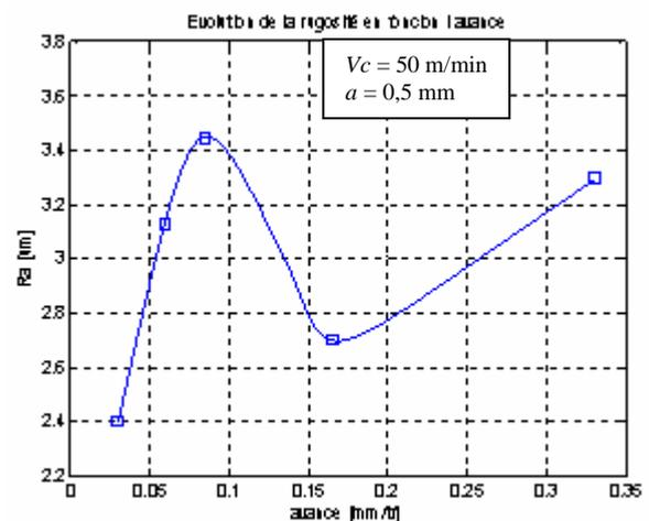
FIG. 4 - Variation de la rugosité avec l'avance.
