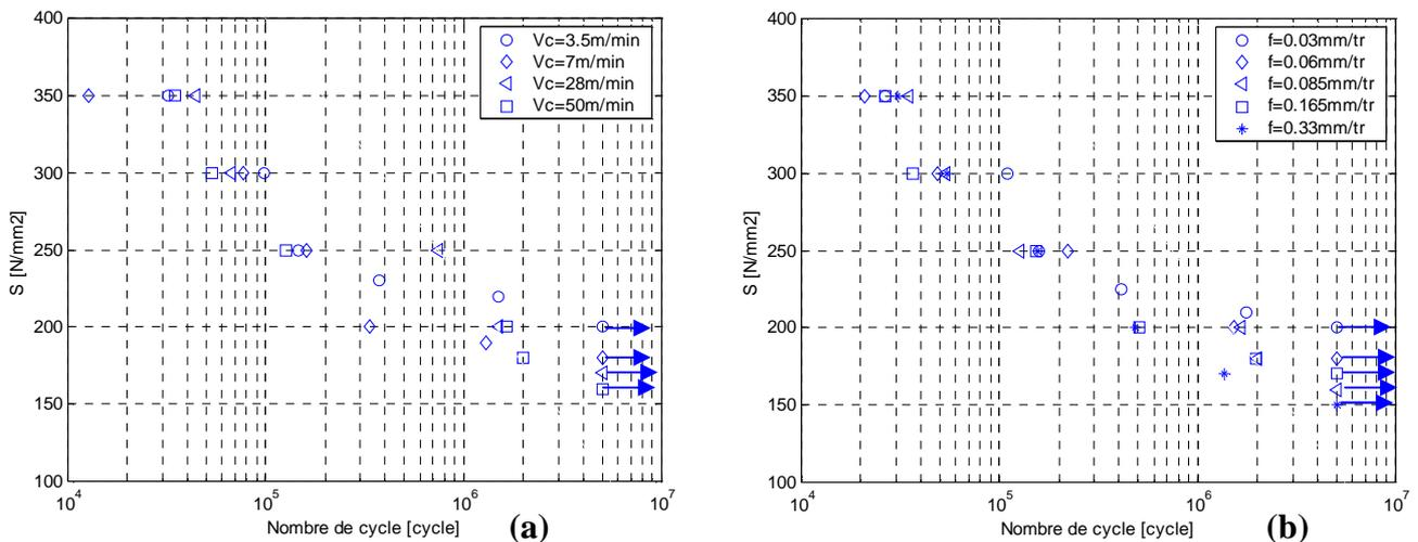
FIG. 6 - Courbe S-N de l'acier XC 48 usiné par tour avec un rayon d'outil  $r = 0.8\text{ mm}$ , profondeur de passe  $a = 0.5\text{ mm}$  à des vitesses de coupe variables (a) et des vitesses d'avance variables (b).
