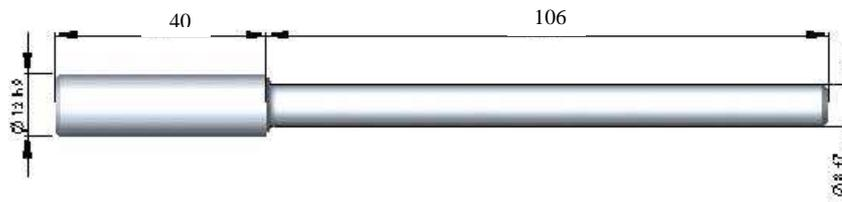
FIG. 2 - Géométrie de l'éprouvette usinée pour les tests de fatigue.
