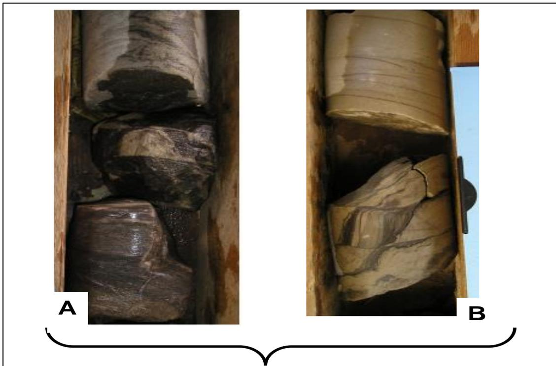
**Figure 19 :** Exemple des fractures rencontrées dans le puits IRLW-2.
