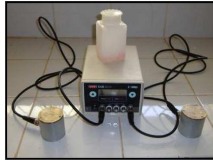
*Figure VI.4 .Testeur à ultrasons
