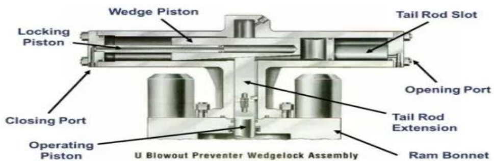
Figure 2. 12 : Verrouillage des obturateurs du Cameron type U.
