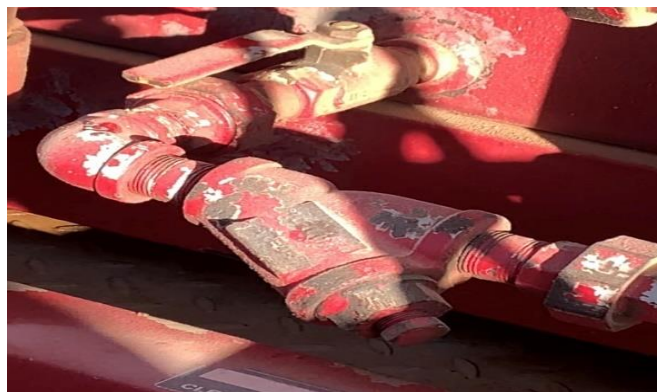
Figure 3. 4 : Collecteur d'aspiration de fluide.
