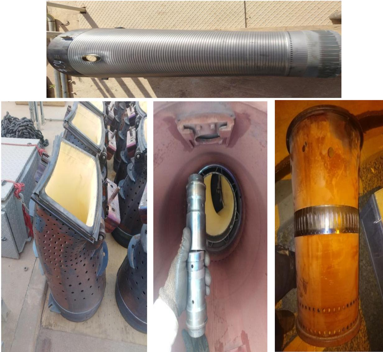
**Figure IV.5 :** Ensemble du Tube de flamme, Pièce de transition, Enveloppe, Tube interconnexion
