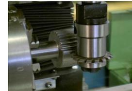
**Figure. II.19** Fraisage à la fraise module
