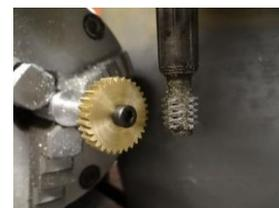
**Figure. II.20** Fraisage à la fraise en bout
