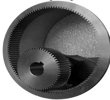
**Figure. II.6** Contact intérieur
