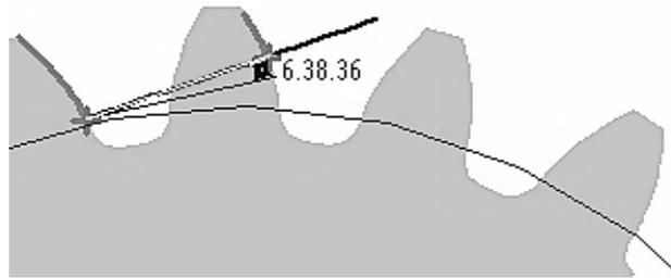
Figure. III.12 angle de pression
