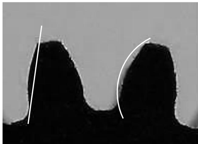
Figure. III.3 Profil d'une dent, comparaison avec une droite et un arc de cercle
