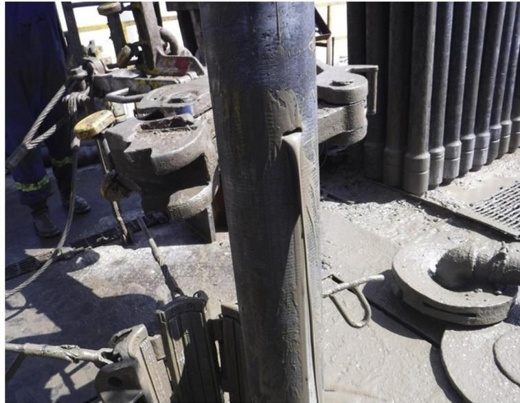
**Figure 5-2 :** Exemple de rupture de tige de forage [22]
