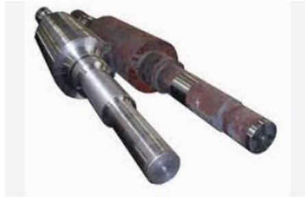
*Figure II 3 : arbre de la turbine*
