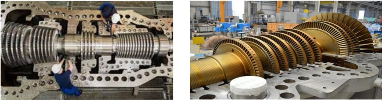
Figure I 20 turbine multi étages
