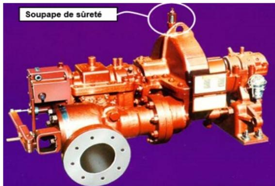
Figure II 22 système de sécurité
