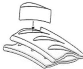
Figure V 8 construction des aubes et de l'anneau (PRV)
