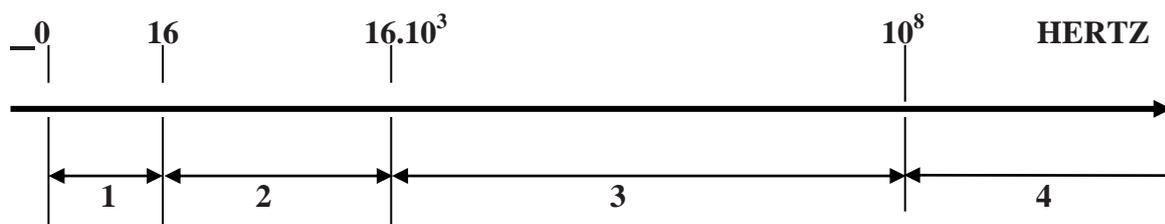
**Figure (IV-07)<sup>(11)</sup> : Echelle des ondes élastique**
