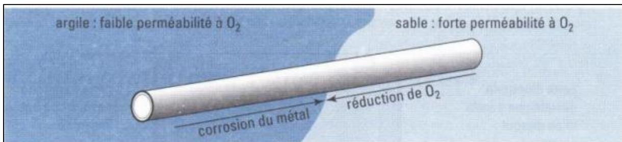
*Fig. I.9 : corrosion caverneuse.*
