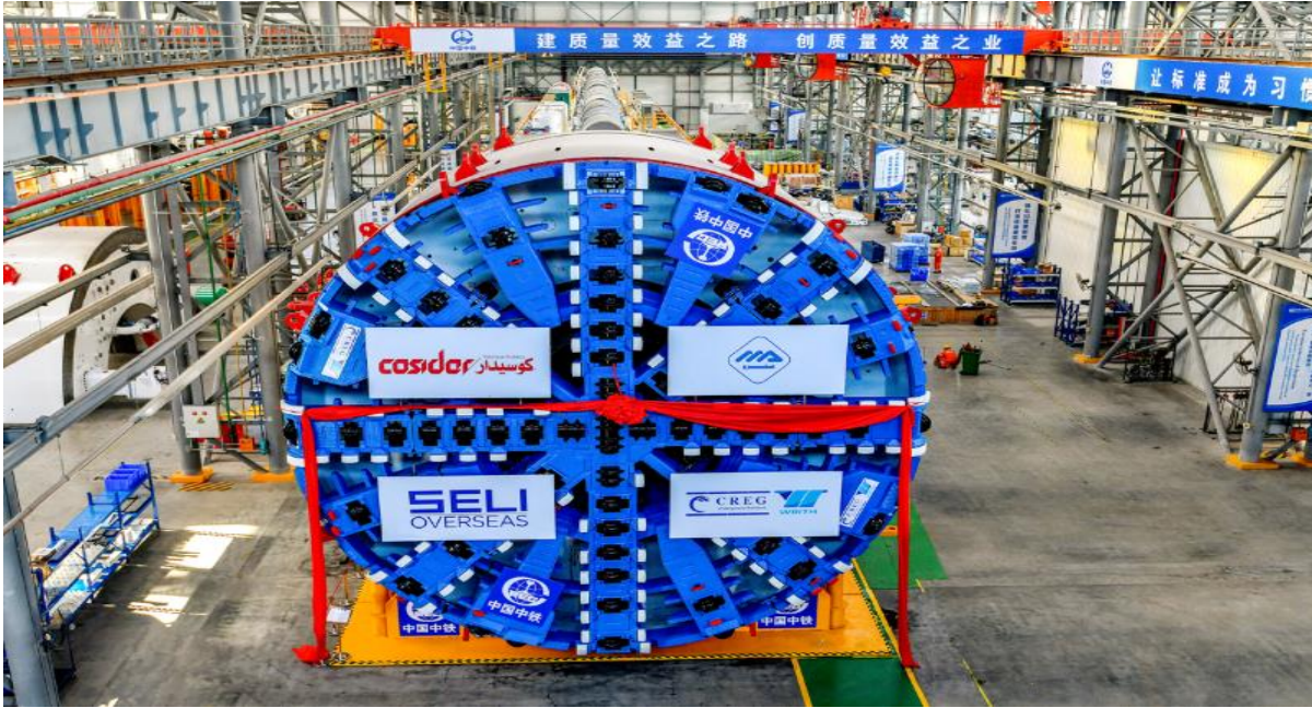
Figure 5-3: Vue du tunnelier utilisé
