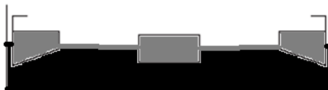
Figure II 6 : Toit flottant à simple pont
