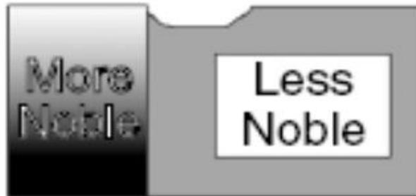
**Figure I.8 :** Corrosion galvanique.
