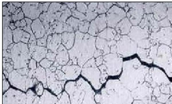
**Figure I.9 :** Corrosion intergranulaire.
