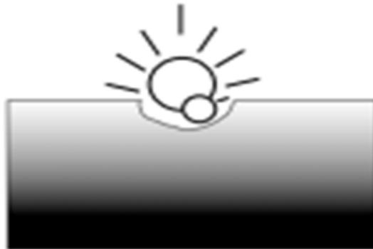
**Figure I.13 :** Corrosion par cavitation.
