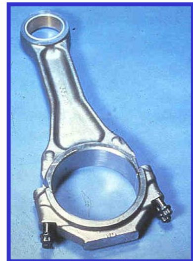
Fig.II.6 : Bielle profil H en acier forge.
