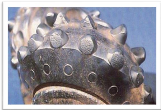
Fig.2.10 : Usure d'un outil de forage par effet thermique.
