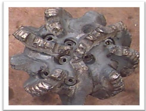
Fig.2.10 : Usure d'un outil de forage par effet thermique.
