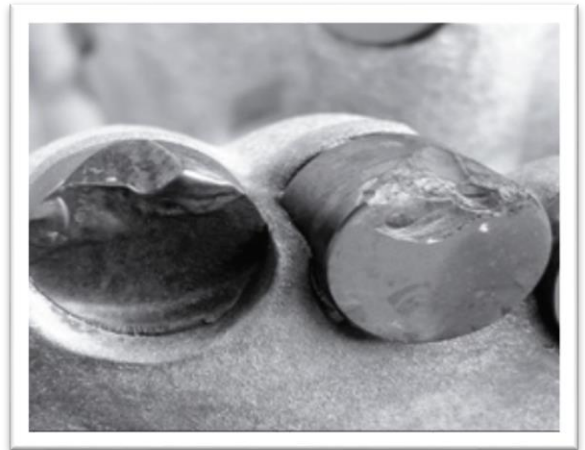
Fig.2.10 : Usure d'un outil de forage par effet thermique.
