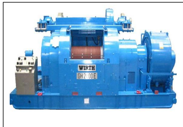
**Fig.II.5 : Le treuil de forage**
