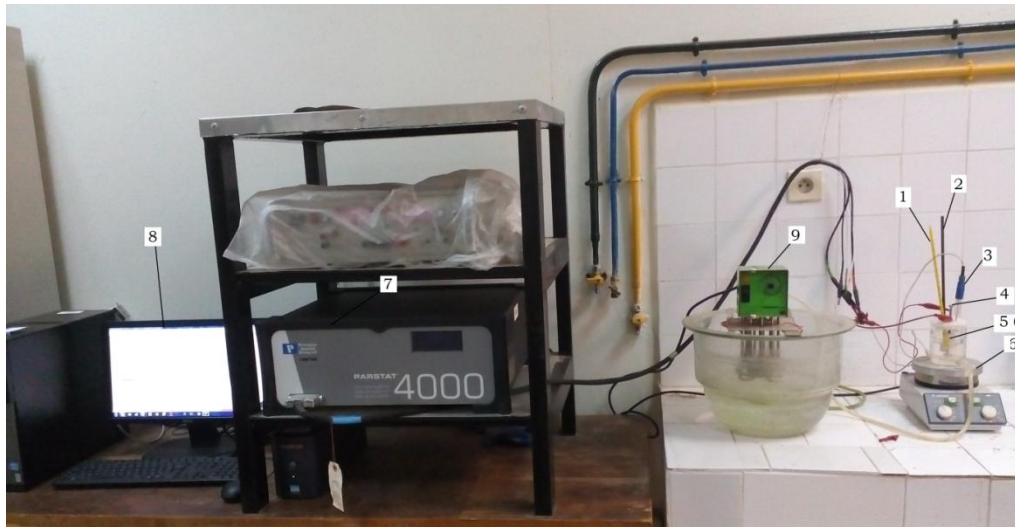
Figure VI.22. Dispositif expérimental du test de corrosion (NaCl 3.5%)
