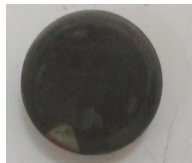
Figure VI.25 : Substrat après le test de la corrosion
