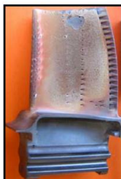
Figure I.14. Ecaillages de la couche de céramique de systèmes barrière thermique pour aube de turbine (photos Snecma)
