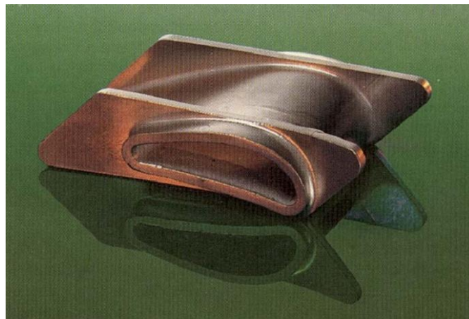
Figure II.20 : TiSi_2 testé dans une chambre de combustion à 1400^{\circ}C pendant 100 h [13]
