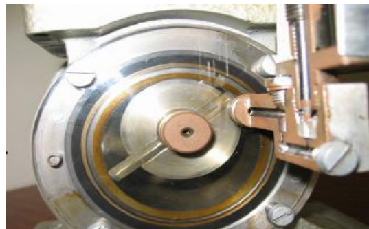
Figure. V.6 Coupe transversale d'une pompe rotative à palette lubrifiée (mono-étagée) [84]
