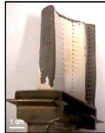
Figure I.15. Disparition de la Couche de céramique par érosion (photo Snecma)
