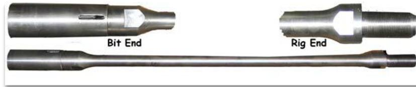
Fig. II.19. Arbre de transmission flexible en Titane.
