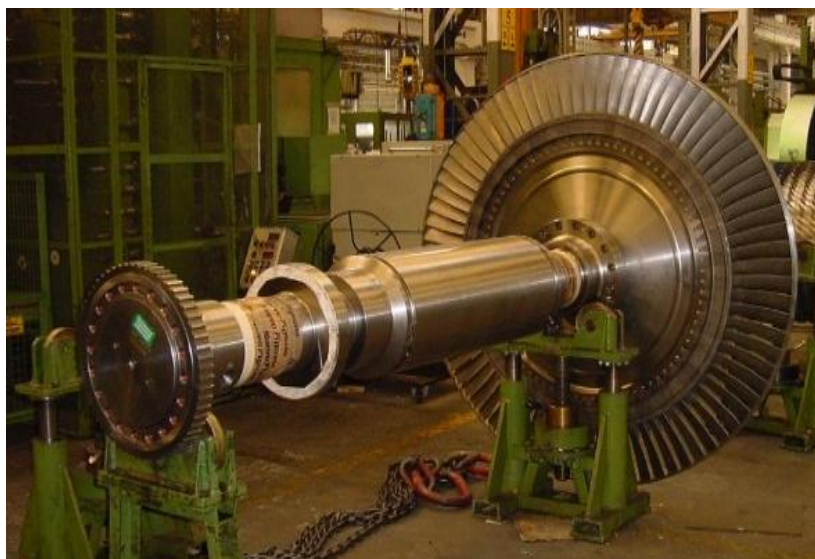
Fig.III.21 : Rotor de la turbine base pression BP
