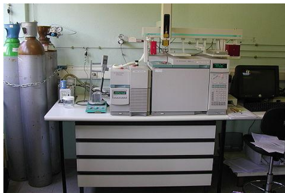
Fig.VI.9 : Dispositifs de chromatographie en phase gazeuse
