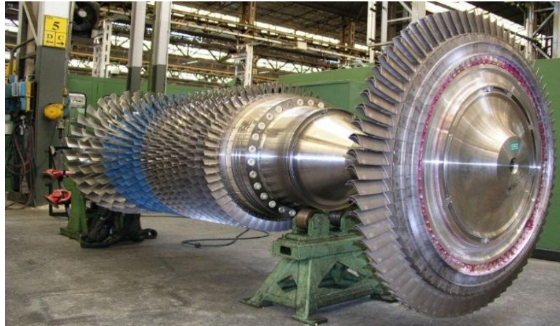
Fig.III.20 : Rotor du générateur de gaz (Roue HP)
