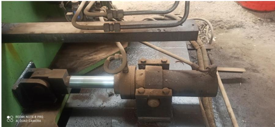
*Figure 1.24. Vérin hydraulique*
