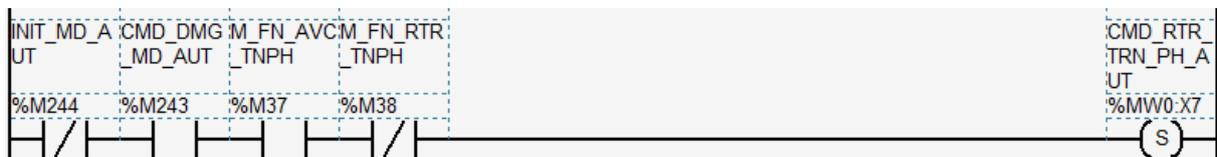
Le tourne planche revient en arrière si, il y'a fin avance tourne planche, capteur avance %M37=1 et il y'a pas fin retour tourne planche en arrière, capteur retour %M38=0
