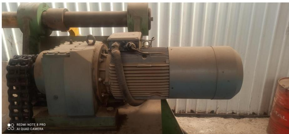
*Figure 1.25. Moteur asynchrone triphasé avec freinage magnétique*
