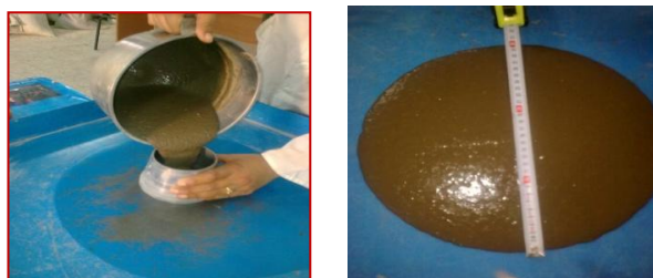
Figure B.6. Essai d'étalement au cône
