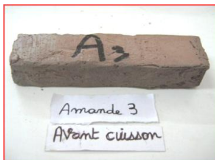
Figure IV.19. Exemple d'échantillon élaborés par la méthode d'introduction de matière organique
