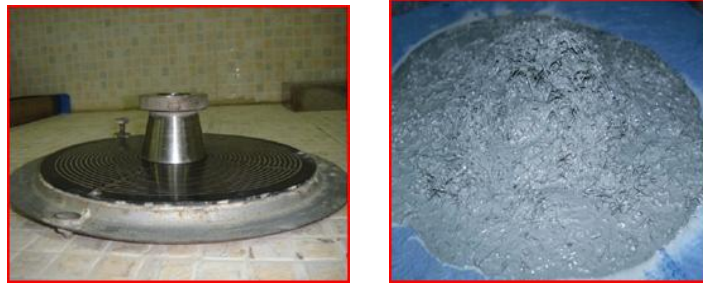
Figure II.6. Essai d'étalement au cône à mortier [26]
