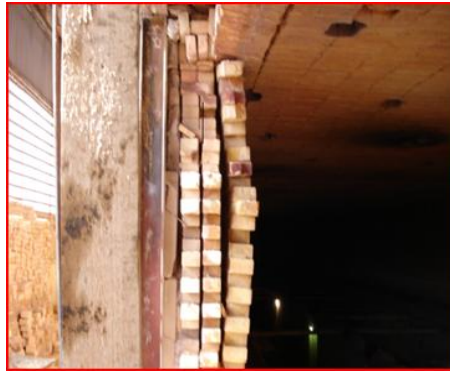
Figure IV.12. Empilement des différents types de briques dans un four tunnel de briqueterie.
