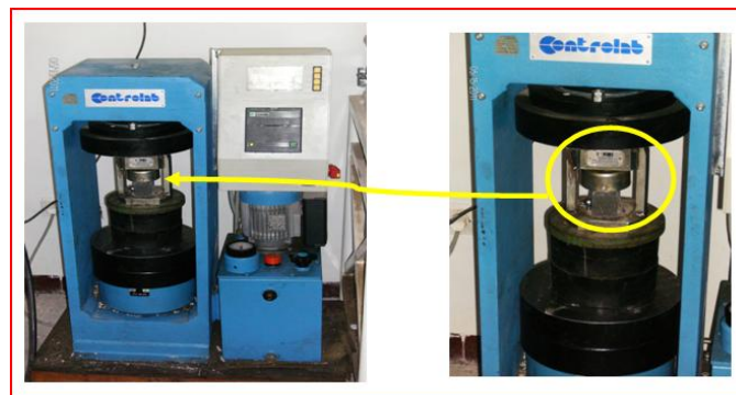
Figure B.8. Montage de l'essai de compression
