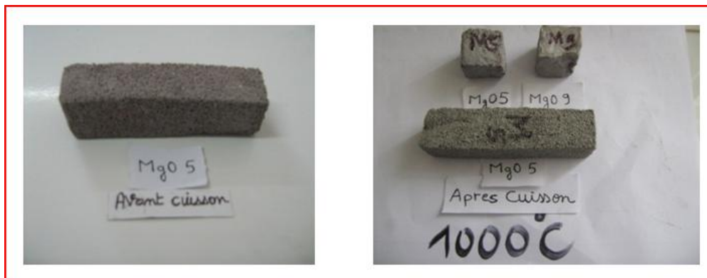
Figure IV.16. Exemple d'échantillons élaborés par la méthode de réplique
