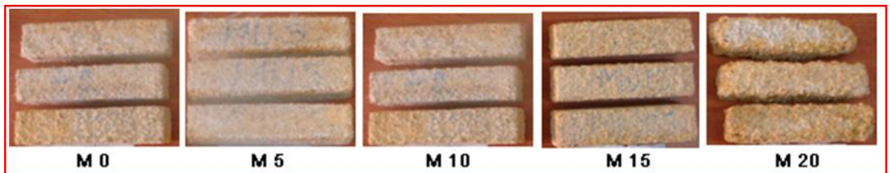
Figure A.15. Etat des éprouvettes après immersion de 60 jours dans 5% H_2SO_4 .
