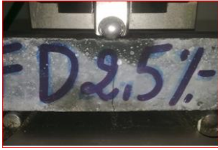
Figure B.14. Mode de rupture des BFUP.
