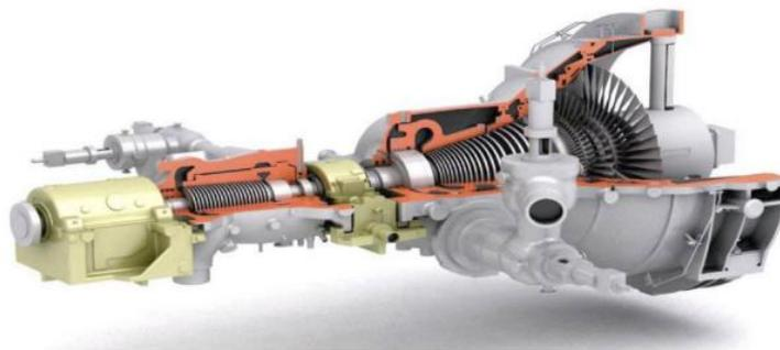
*Figure I.11: Schéma de la turbine à vapeur(ST)*
