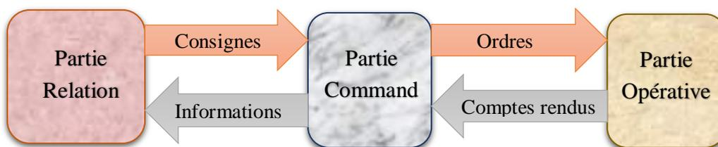
Figure III.12 : Les parties d'un système automatisé.
