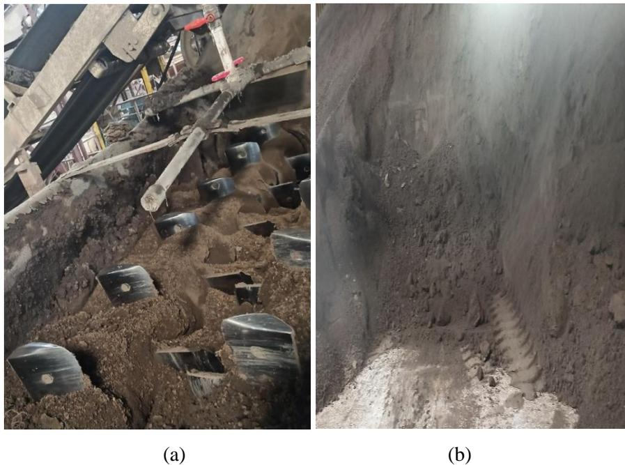
Figure I.13 : Mouilleur-mélangeur (a) et mélange obtenu (b).
