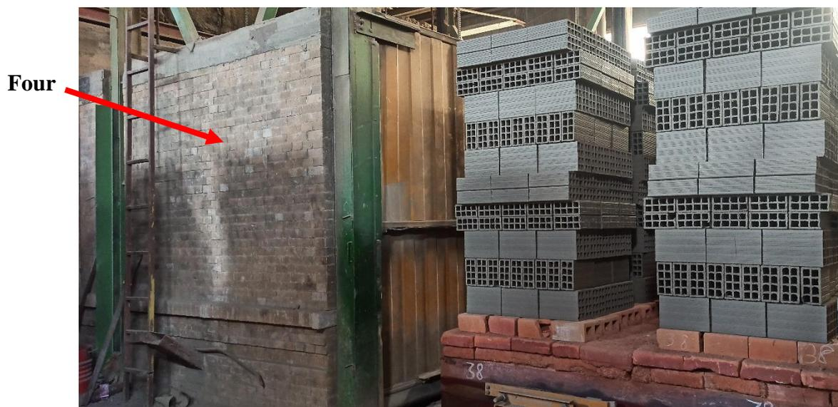
Figure I.19 : Acheminement des briques séchées vers le four.
