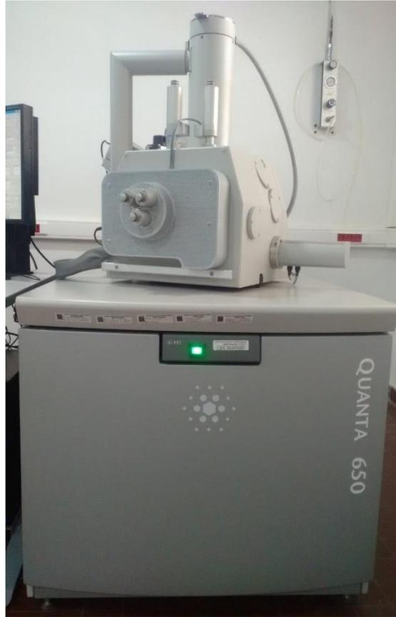
Figure II.11 : Microscope électronique à balayage QUANTA 650 W.
