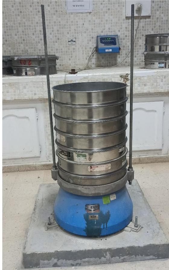
Figure II.5 : Tamiseuse de marque CONTROLS modèle D409/S.
