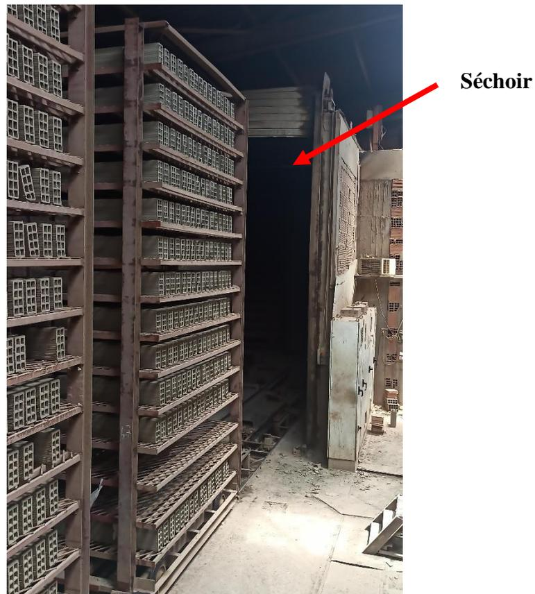
Figure I.18 : Acheminement des briques crues vers le séchoir.
