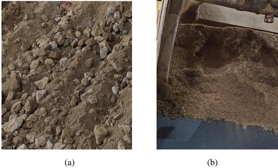
Figure I.12 : Aspect du tuf avant (a) et après (b) tamisage.
