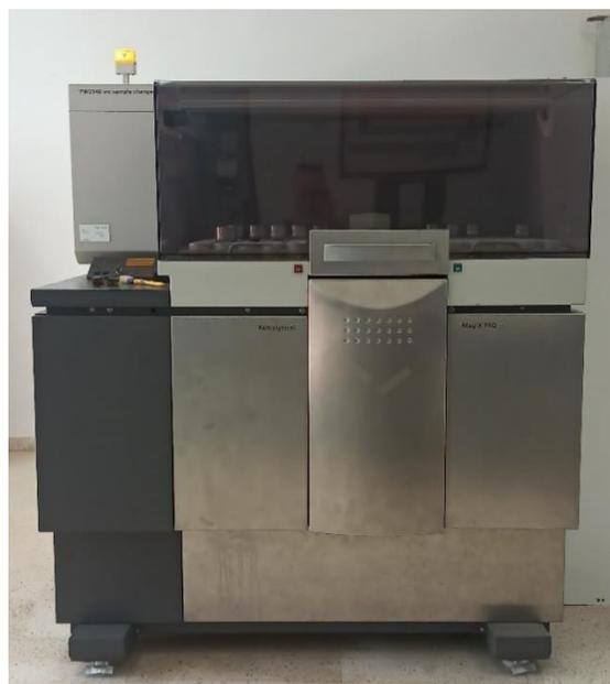
Figure II.9 : Spectromètre à fluorescence X PANalytical Magix Pro.
