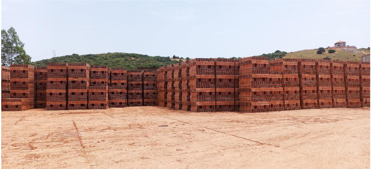
Figure I.21 : Briques cuites conditionnées.
