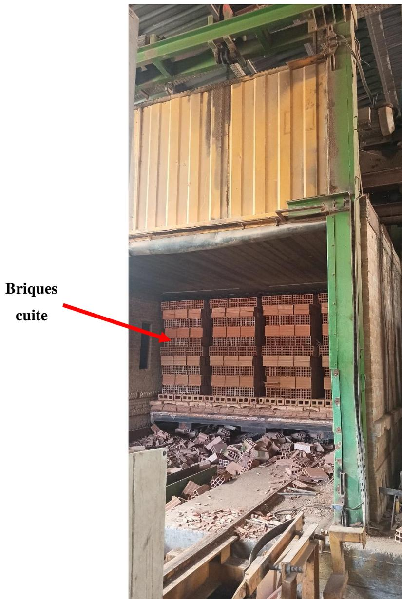
**Figure I.20 :** Ouverture automatique du four après cuisson des briques.
