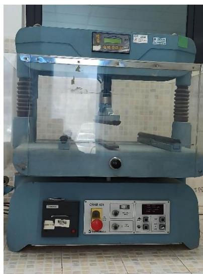
**Figure II.15 :** Essai de flexion à trois points.
