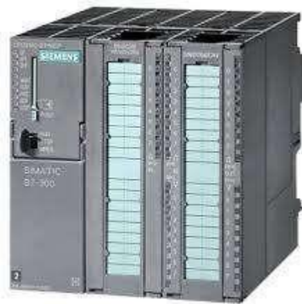
Figure III. 2 : Exemple d'automate modulaire
