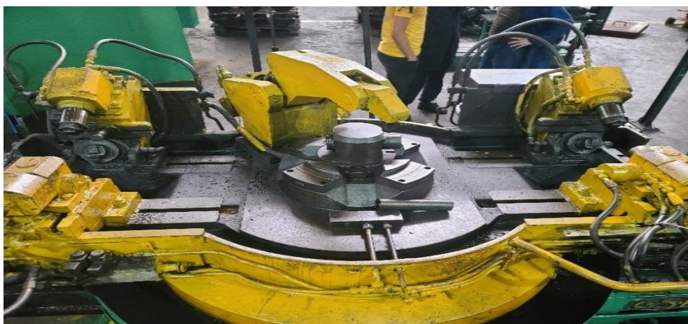
Figure II. 3 : Ensemble des vérins de brid
