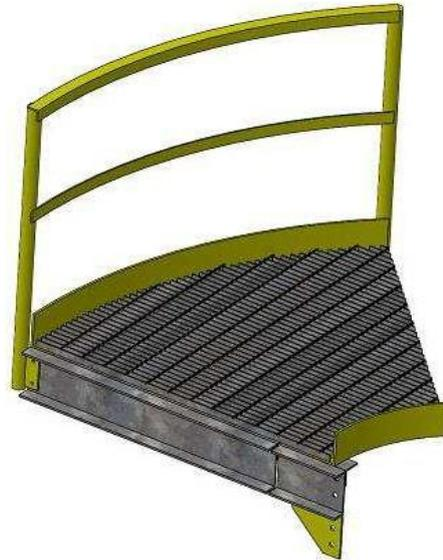
**Figure 4.12** : une partie de la plateforme circulaire montée sur la colonne
