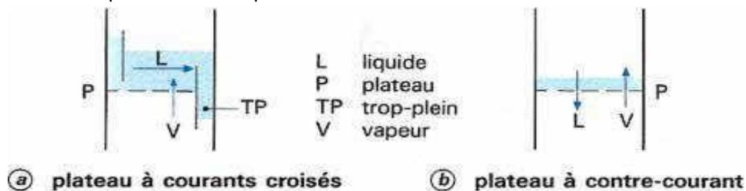
Figure 2.11: principe de fonctionnement des plateaux
