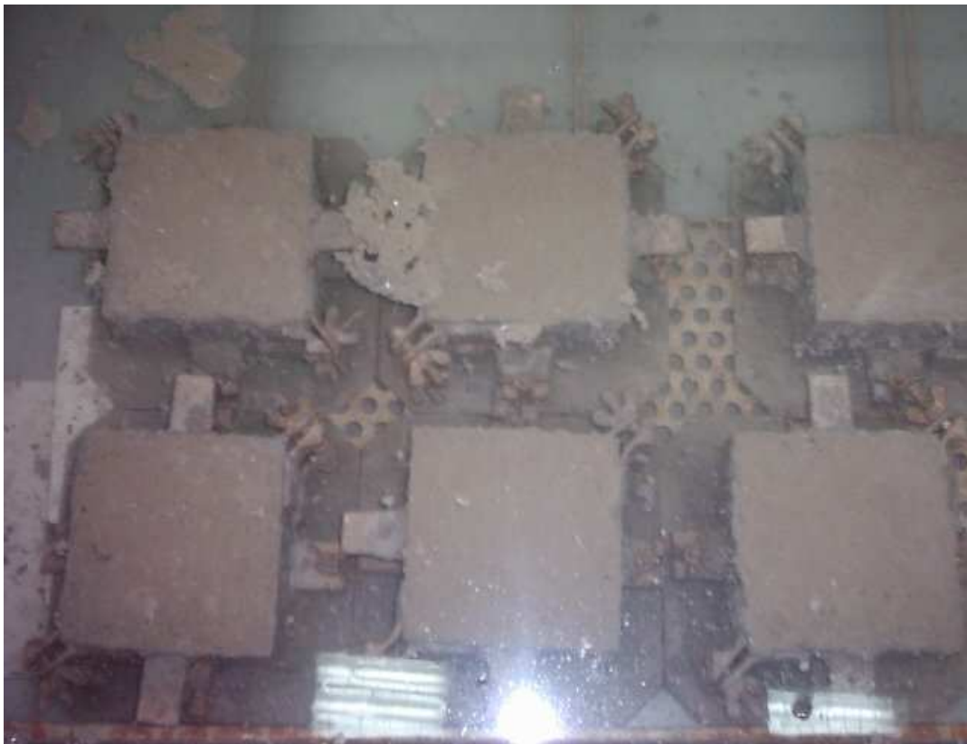
Figure n°44 : Eprouvettes en béton immergées dans le caisson pour traitement thermique
