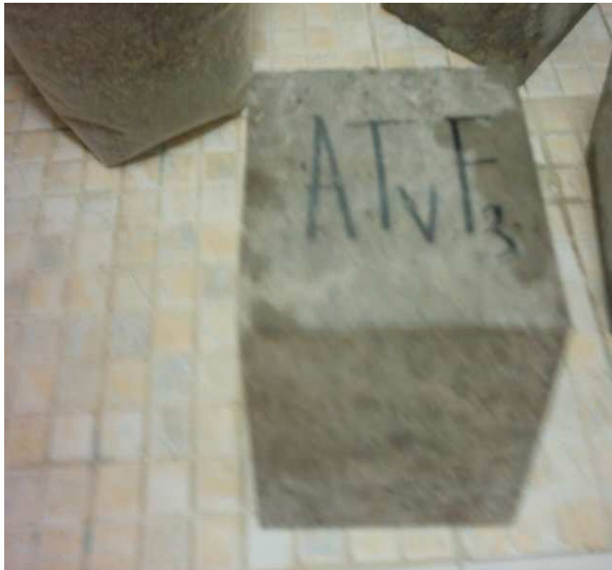
Figure n°42 : éprouvette à béton d'essai de 15x15x15 cm de dimensions.
