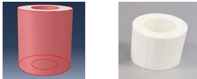
Figure. 2 : modèle CAO vs le modèle imprimé en 3D
