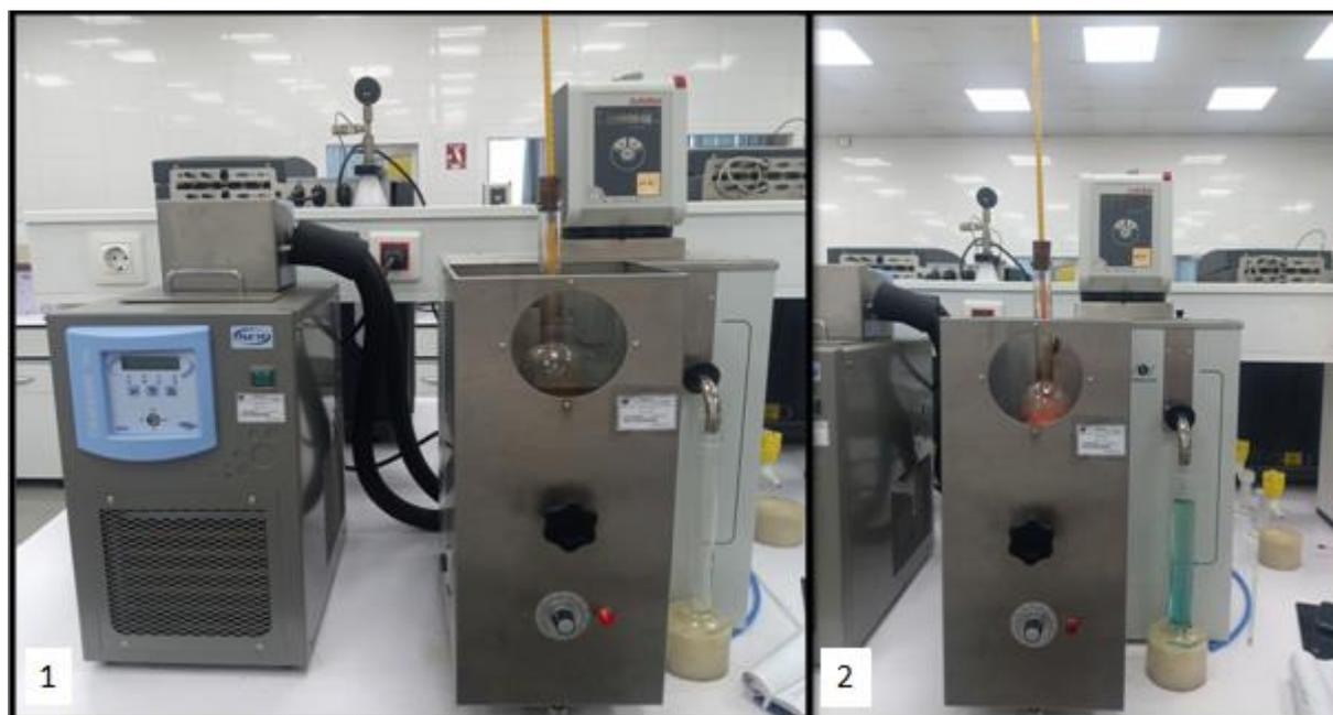
**Figure IV.27 : Dispositif de distillation atmosphérique.**
