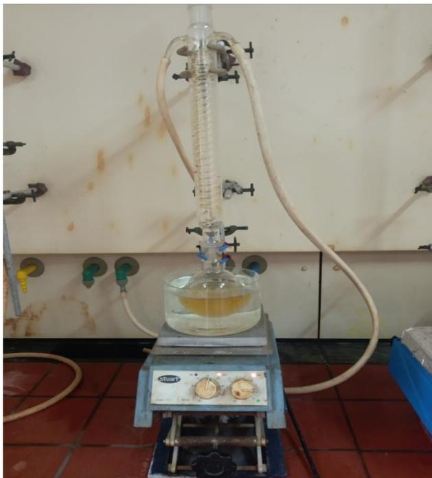
Figure IV.4 : Aspect de milieu réactionnel de la réaction de trans-estérification à  $t = 60$  min.
