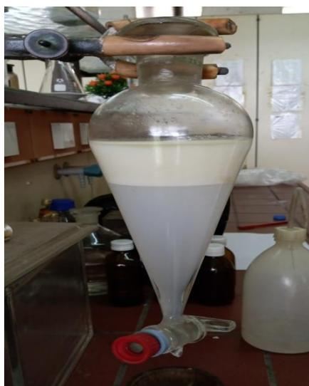
Figure IV.19 : Lavage de biodiesel obtenue par chauffage ultra-sons (Bio 3).
