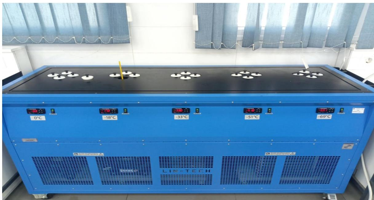
Figure IV.24 : Bain de refroidissement pour la mesure de point d'écoulement.
