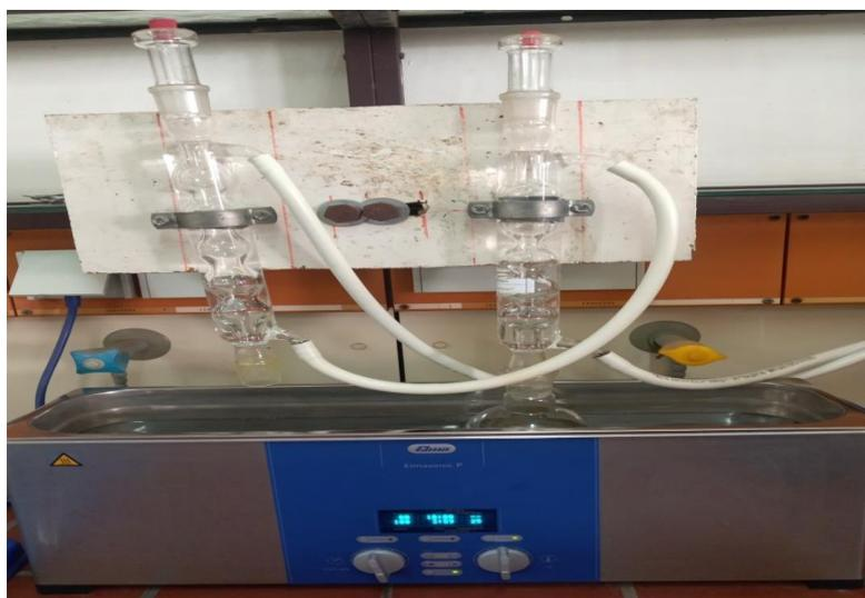
Figure IV.18 : Dispositif expérimental de trans-estérification sous un bain à ultra-sons.
