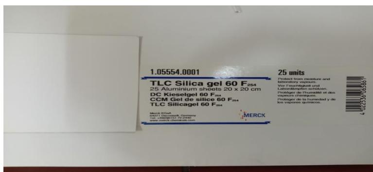
**Figure IV.33 : plaque de CCM d'aluminium étalée par gel de silice.**
