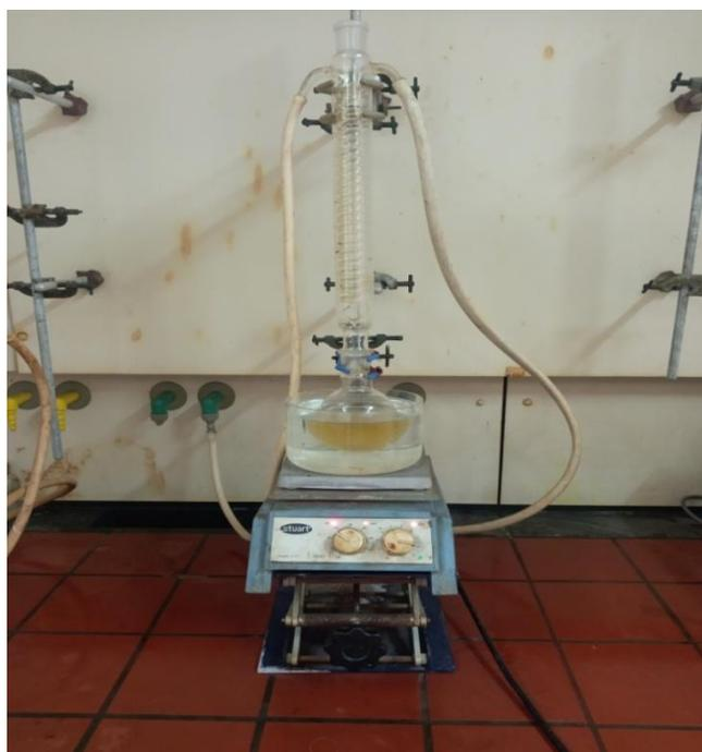
**Figure IV.3 : Aspect de milieu réactionnel de la réaction de trans-estérification à  $t = 30$  min.**
