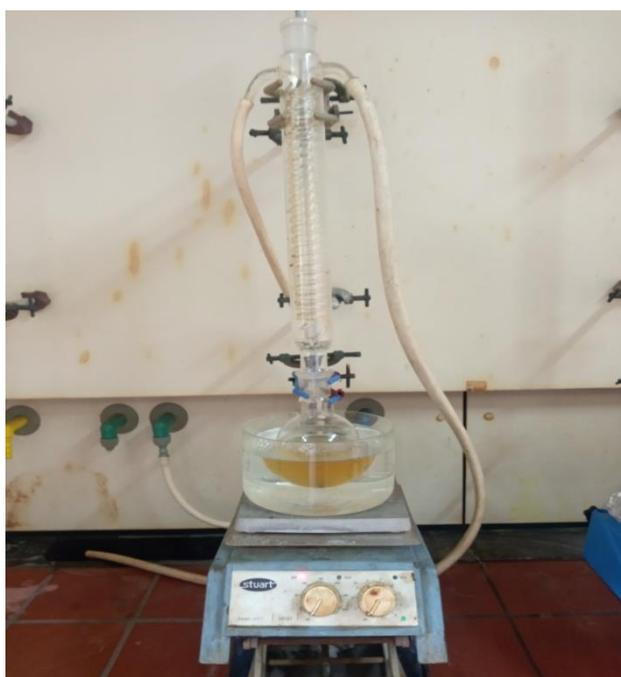
Figure IV.5 : Aspect de milieu réactionnel de la réaction de trans-estérification à  $t = 120$  min.
