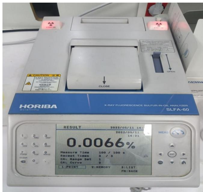
Figure IV.26 : Spectromètre des rayons X-Fluorescence.
