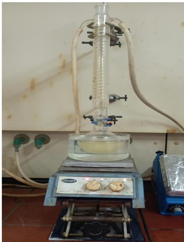
**Figure IV.2 : Dispositif expérimental de trans-estérification sous chauffage conventionnel.**
