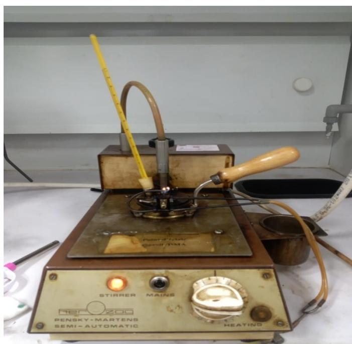
Figure IV.25 : Appareil de mesure de point d'éclair.
