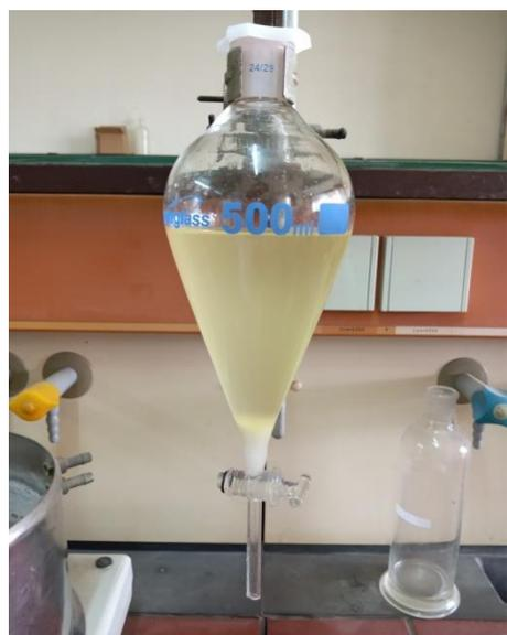
**Figure IV.7 : Lavage de biodiesel**
