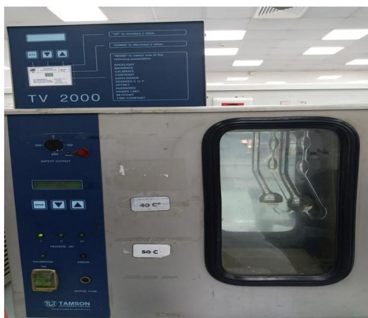
**Figure IV.23 : Appareillage de mesure de viscosité**
