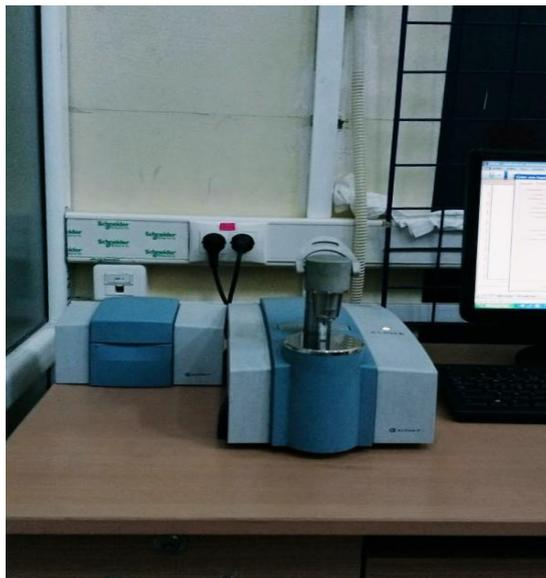
Figure IV.36 : Dispositif de spectroscopie infrarouge.
