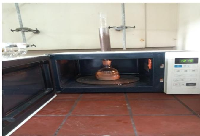
**Figure IV.12 : Dispositif expérimental de transestérification sous chauffage micro-ondes.**
