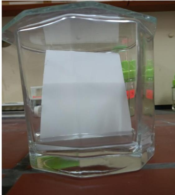
Figure IV.34 : L'élution de la plaque CCM dans la cuve.
