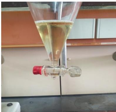
**Figure IV.9 : Lavage de biodiesel obtenue par chauffage conventionnel (Bio 1).**
