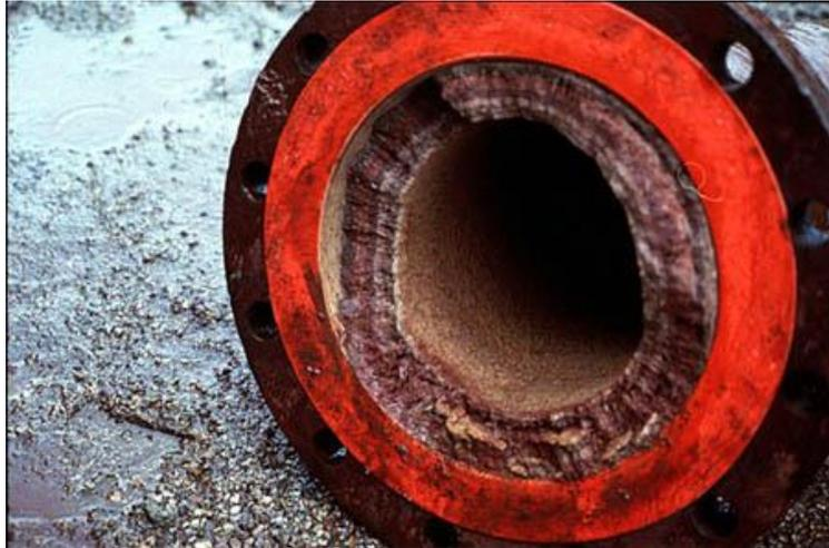
**Figure I.6:** Dépôt de sulfate de calcium.
