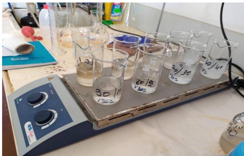
Figure II.16: Photo des mélange des deux eaux V301 et V302 « 60/40 » « 70/30 » « 80/20 »
