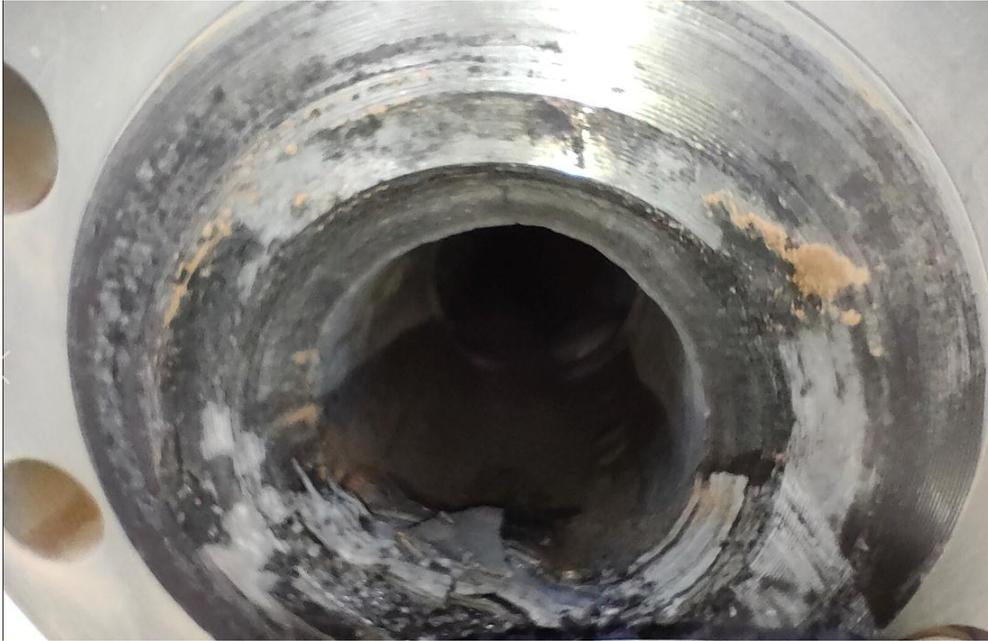
**Figure II.1:** Photo du réservoir bouché avec le dépôt
