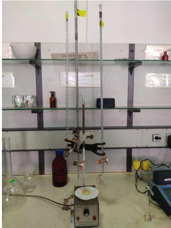
Figure II.6: Dosage des chlorures
