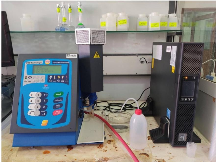
Figure II.11: Spectrophotomètre de flamme
