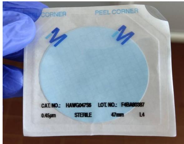
Figure II.17: Papier filtre 47mm de diamètre
