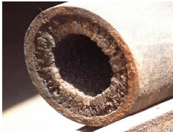
**Figure I.5:** Dépôt de sulfate de strontium.
