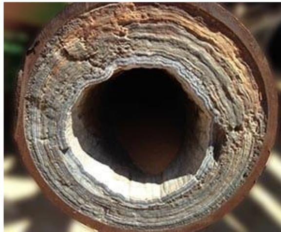
**Figure I.7:** Dépôt de sulfate de baryum.
