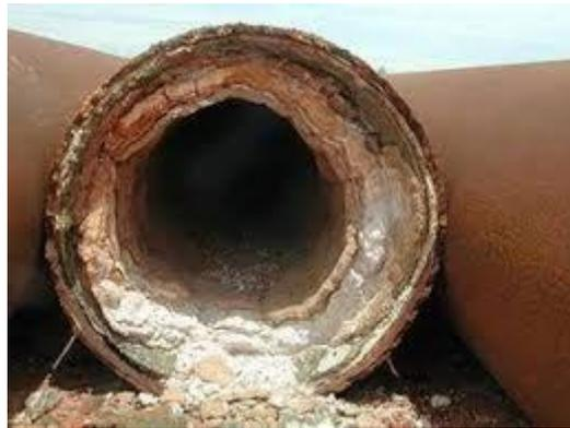
**Figure I.4:** Dépôt des carbonates de calcium.
