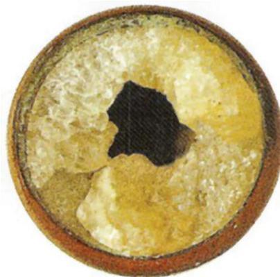
**Figure I.3** : Dépôt des chlorures de sodium.
