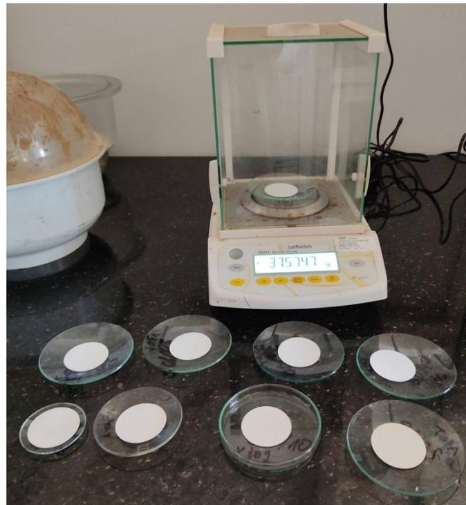
Figure II.18: La pesé des filtre vierge
