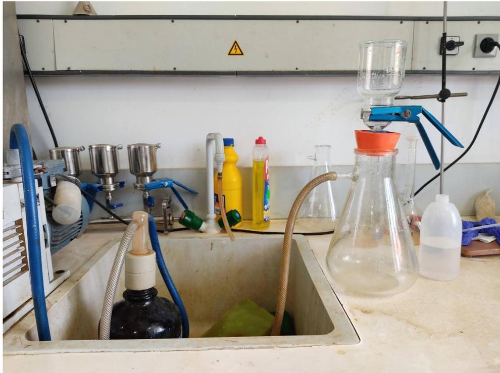
Figure II.19: La filtration sous vide du mélange des eaux V301 et V302
