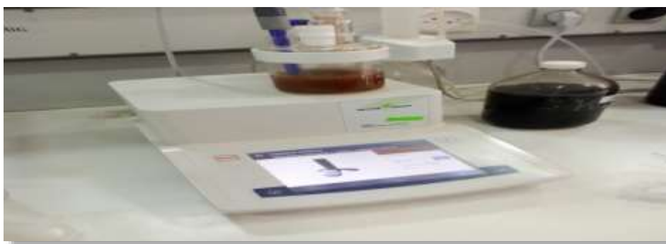
Figure 4.16 : L'appareil de mesure de teneur en eau par la méthode de Karl Fischer
