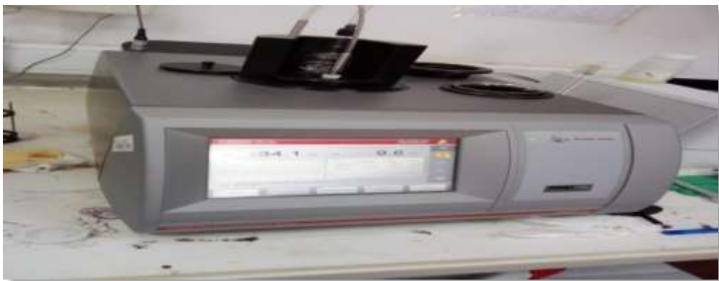
Figure 4.14 : L'appareil de mesure de température limite de filtrabilité
