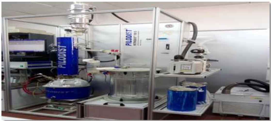
Figure 4.19 : L'équipement de la distillation TBP
