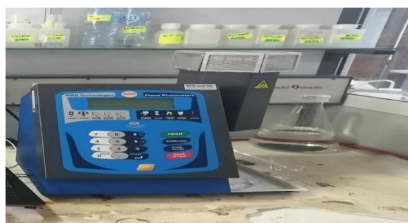
Figure IV.12 : La photométrie de flamme
