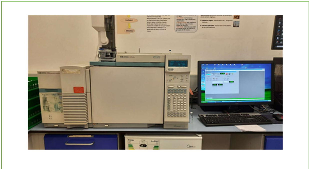
FigureII.12 : La chromatographie en phase gazeuse couplée à la spectrométrie de masse (GC-MS) (CRAPC)
