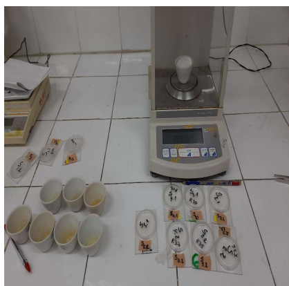
La pesée des filtres et creusets
