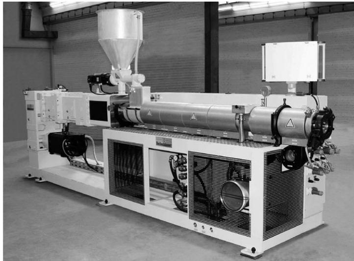
**Figure IV.1.** Extrudeuse Reifenhauser.
