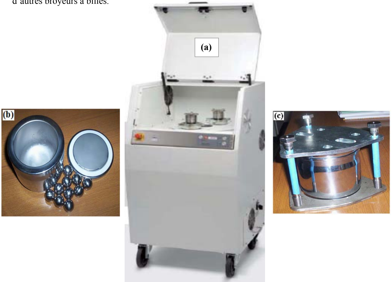
Figure II. 1. (a) Vario-broyeur planétaire innovant « pulverisette 4 », (b) jarre et billes de broyage et (c) jarre hermétiquement fermée avec un serrage approprié.
