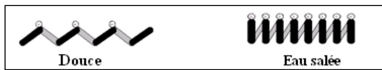
Fig. V.1 : Effet de concentration d'électrolyte sur la configuration de polymère.
